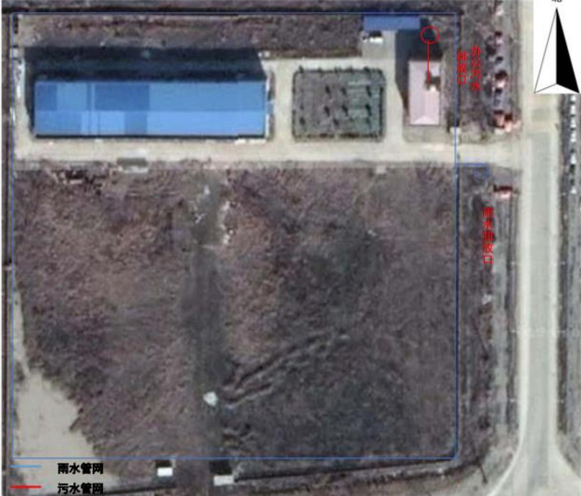
图4.项目雨污水流程图
